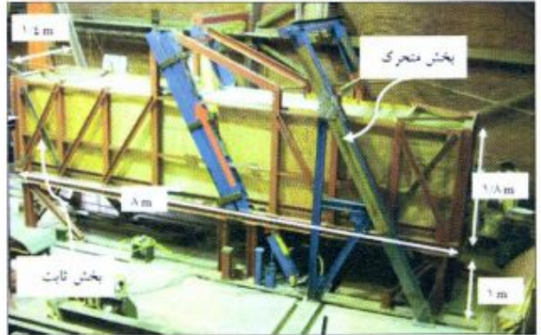
شکل ۱- نمای وسیله آزمایش ساخته شده جهت انجام آزمایش برای حالت گسلش معکوس
