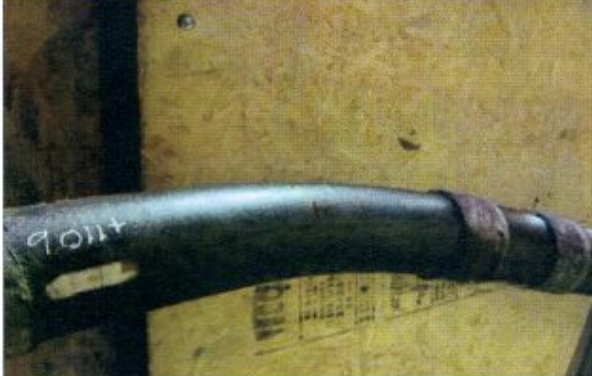
شکل ۳- الف) کماتش موضعی جدااره لوله (آزمایش ۵)، ب) کماتش تیرمانند (آزمایش ۲)
