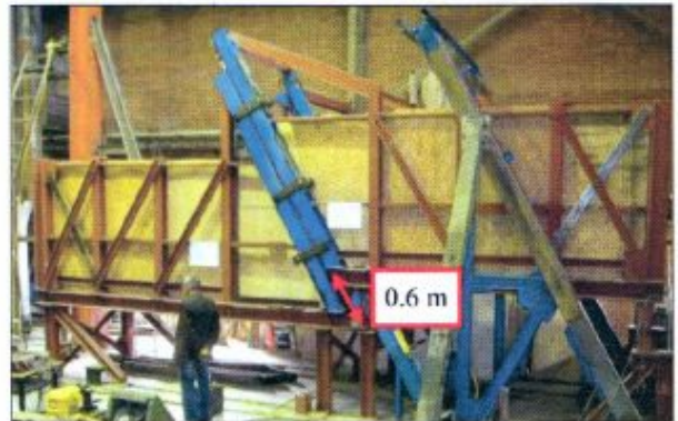
شکل ۲- وسیله آزمایش ساخته شده جهت انجام آزمایش برای حالت گسلش معکوس پس از ۰/۶ متر جابجایی
